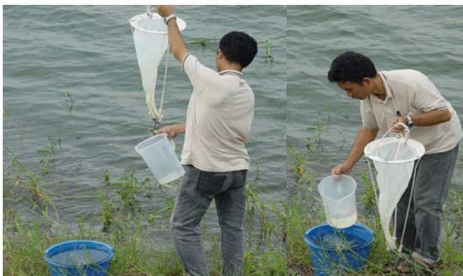
ภาพที่ 26 เก็บตัวอย่างน้ำเพื่อการวิเคราะห์ปริมาณและชนิดแพลงค์ตอน (พืชน้ำที่มีขนาดเล็กมาก) ที่มีในแหล่งน้ำ
